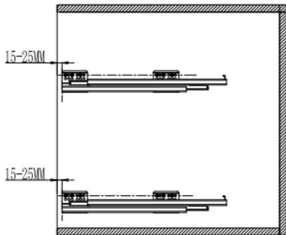
2. Установите корзину на направляющие. Зафиксируйте их с помощью винтов.
