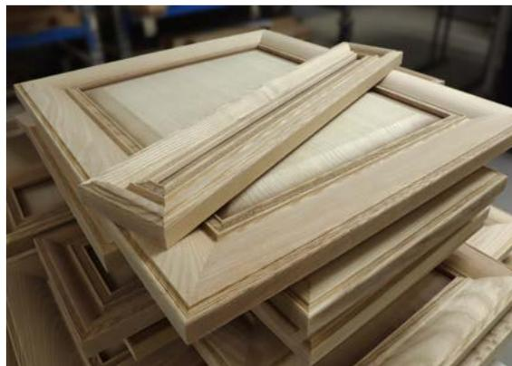
Участок шлифовки фасадов перед процессом окрашивания.
